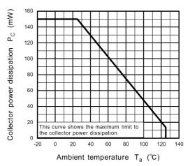
Fig. 11.2 P<sub>C</sub> - T<sub>a</sub>
