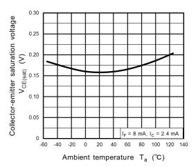
Fig. 11.10 V<sub>CE(sat)</sub> - T<sub>a</sub>
