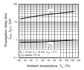
Fig. 11.17  $t_{pHL}$ ,  $t_{pLH}$  -  $T_a$
