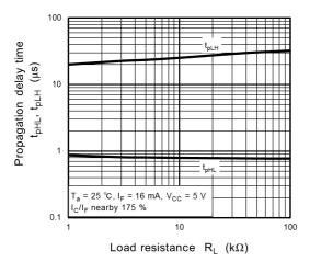
Fig. 11.15  $t_{pHL}$ ,  $t_{pLH}$  -  $R_L$
