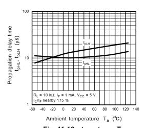
Fig. 11.16  $t_{pHL}$ ,  $t_{pLH}$  -  $T_a$
