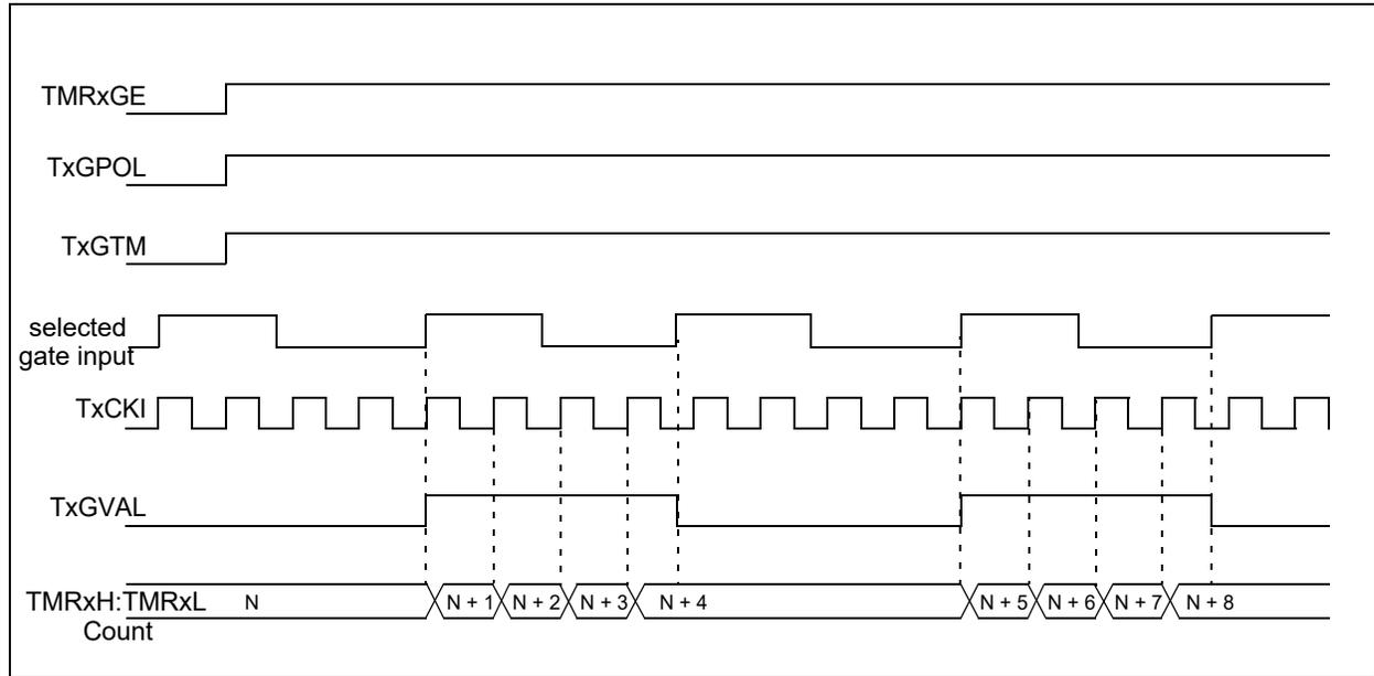
**FIGURE 28-5: TIMER1 GATE SINGLE-PULSE MODE**
