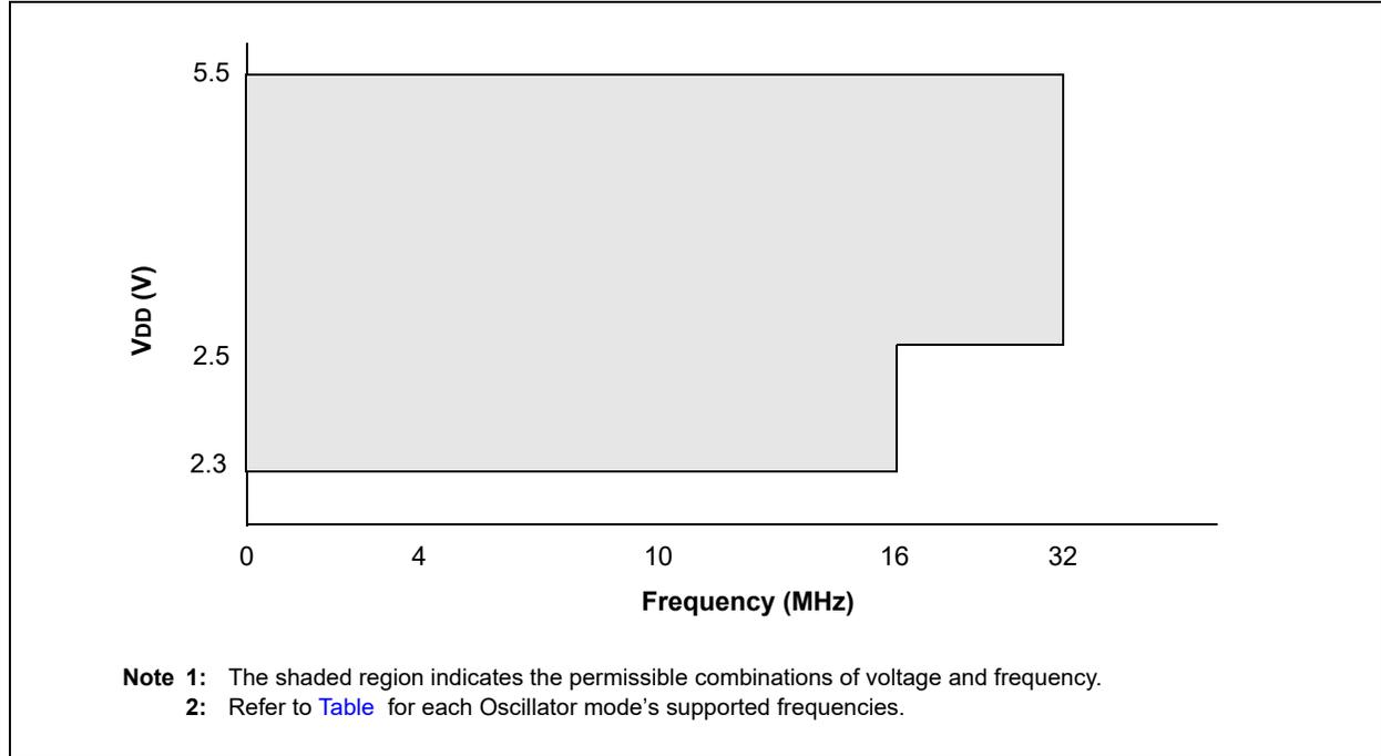
**FIGURE 37-2: VOLTAGE FREQUENCY GRAPH,  $-40^{\circ}\text{C} \leq T_A \leq +125^{\circ}\text{C}$ , PIC16LF18857/77 ONLY**
