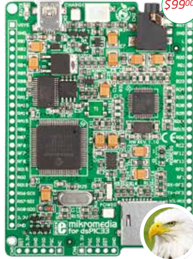
mikromedia for dsPIC33 (features dsPIC33FJ256GP710A)
