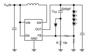
Figure 4. Soft-Start Circuit
