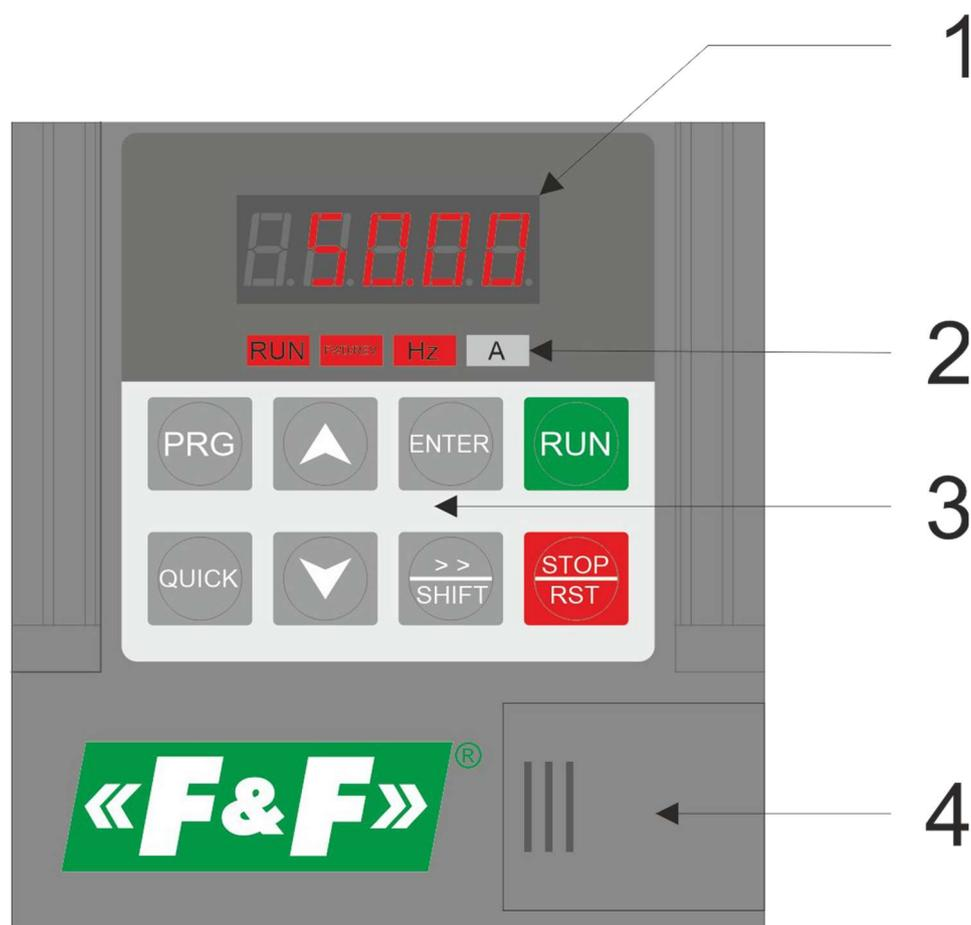
**Fig. 9) Inverter control panel**
