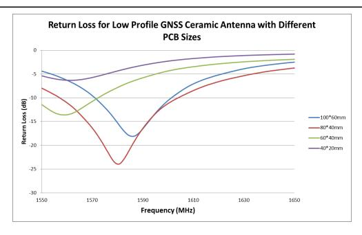
FIGURE 4.3.1 RETURN LOSS OF ANTENNA COMPARISON AT GPS/GALILEO/BEIDOU/GLONASS BAND MOUNTED ON DIFFERENT GROUND SIZES
