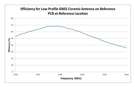
FIGURE 2.3 EFFICIENCY OF ANTENNA AT GPS/GALILEO/BEIDOU/GLONASS BAND ON REFERENCE PCB AT REFERENCE LOCATION IN FREE SPACE
