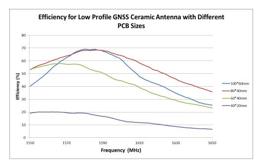
FIGURE 4.3.2 EFFICIENCY OF ANTENNA COMPARISON AT GPS/GALILEO/BEIDOU/GLONASS BAND MOUNTED ON DIFFERENT GROUND SIZES
