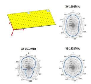
FIGURE 6.3 RADIATION PATTERN OF ATNENNA AT 1602MHZ AT RECOMMENDED LOCATION
