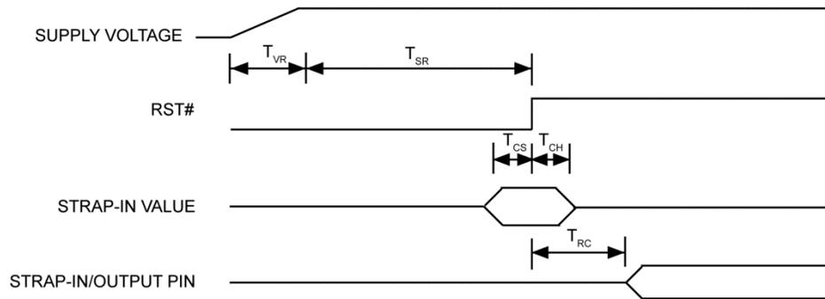
**Figure 24. Reset Timing**
