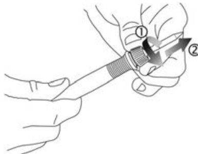
Fig. 1: Débloquer la panne à souder à souder [1] et l'extraire [2]
